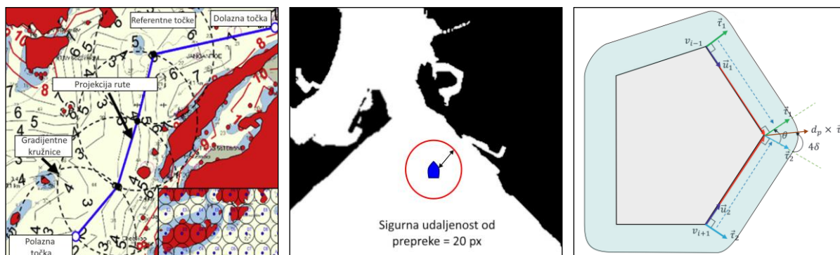
Slika 6. Prikaz različitih pristupa određivanja sigurnosne udaljenosti od statičkih prepreka: ruta s gradijentnim kružnicama rizika i konturama rizika 62 (lijevo), sigurnosna udaljenost u pikselima 63 (sredina) i sigurnosna zona 28 (desno). Prilagodio autor na temelju izvornika
