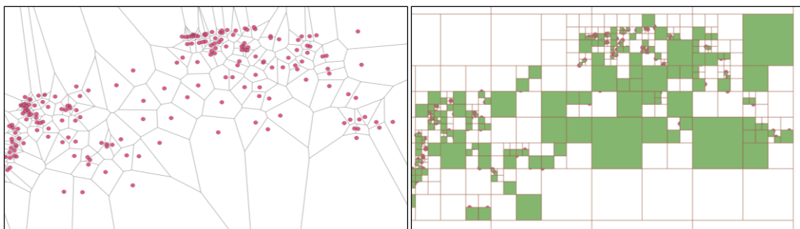
Slika 26. Diskretizacija Voronojevim dijagramima i četvornim stablima. Priredio autor
