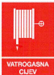
Simbol za vatrogasne cijevi može se koristiti i za hidrantske ormariće
